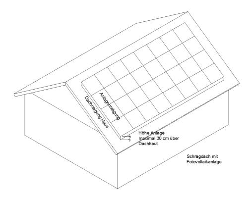
Hiervon ausgenommen sind flache oder flach geneigte Dächer (Neigungen zwischen  $0^{\circ}$  und  $7^{\circ}$ ), auf denen freistehende Anlagen bis zu einer Höhe von 1,50 m zulässig sind. Diese müssen aber mindestens 2,0 m von den Rändern des Daches zurückbleiben.
