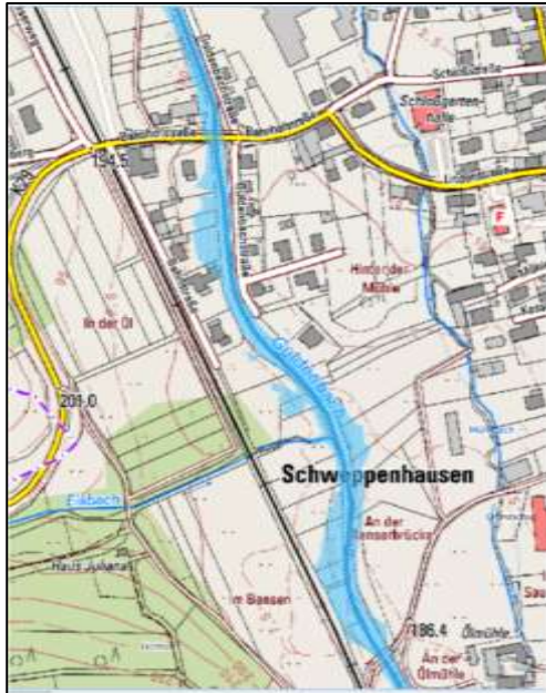
Überflutungsfläche für HQ 100
